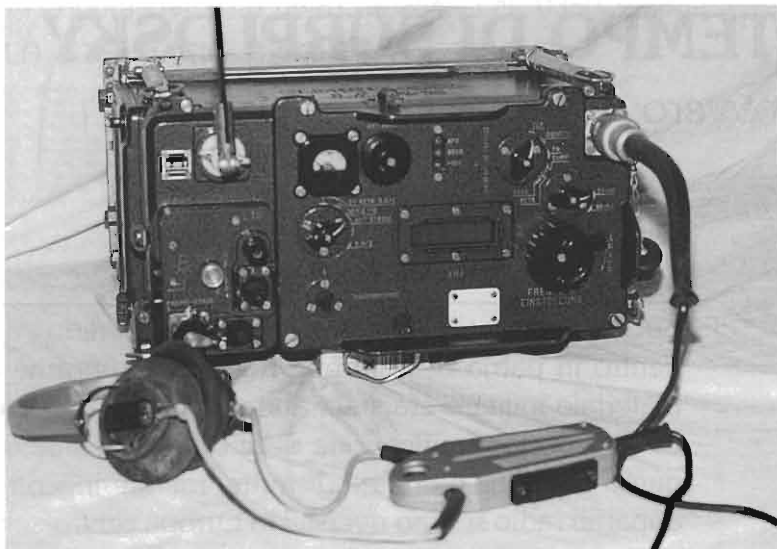
Foto 2 - Stazione P 107-T digitale, ultima versione della serie 107, tutt'ora in dotazione alle forze armate russe.
