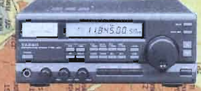
FRG 100 Ricevitore multibanda HF da 50 KHz a 30 MHz. Alta selettività e doppia conversione in SSB, CW AM, FM 50 memorie.
