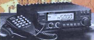
FT 2400H/2500H - RTx mobile 144/146 MHz - 50W RF - 31 memorie - di eccezionale robustezza meccanica
