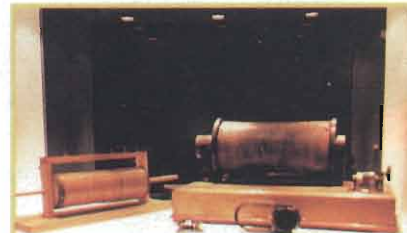
Accordatore d'antenna "Long Tom" (1901) - Rocchetto di Ruhmkorff da 15 kW per perturbazioni locali (1898/99) - Auricolare Collier-Marr amplificato
